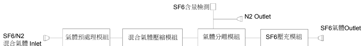
圖 2-1 SF 6 /N 2 快速回收分離儲存裝置系統流程圖
